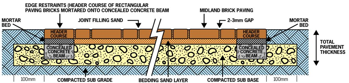
FIGURE 5: Concrete Edge Restraint
